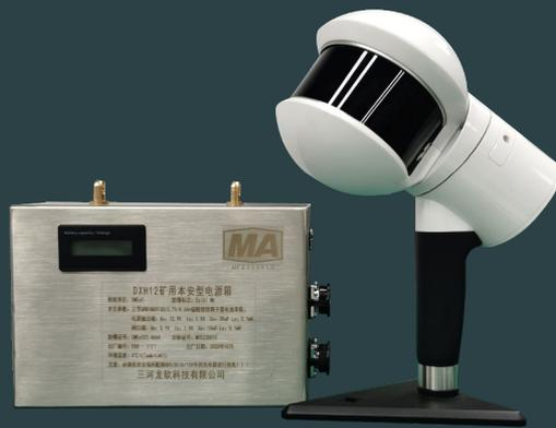
GHJS12 矿用本安型三维激光扫描仪，采用本质安全型防爆设计，通过了煤安认证！产品适用于井工煤矿、露天煤矿等场景，可用于煤矿巷道三维点云数据分类、三维模型重建、井下变电硐室和水泵房等场景建模；可为煤矿智能掘进提供实时点云数据，用于巷道中线提取、断面分析；可用于露天矿高精度点云数据获取，实现坡顶坡底线、边坡角的自动提取，同时可自动计算露天矿月度、季度开采方量；可生成全矿井巷道数字孪生数据，为智慧矿山“一张图”提供真实底图！
